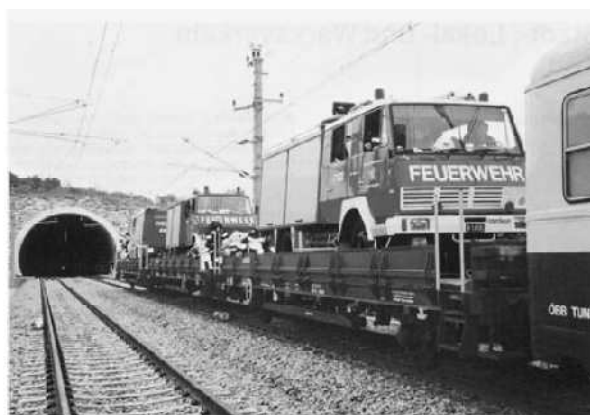
شکل ۶-۴- قطار نجات همراه با واگن حمل وسایل نقلیه نجات جاده‌ای / مرکز بهره‌برداری قطار [۱۶]
